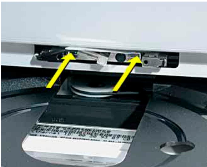
9. AirMac カードの透明なプラスチックのつまみをコンピュータ内部に収めます。
