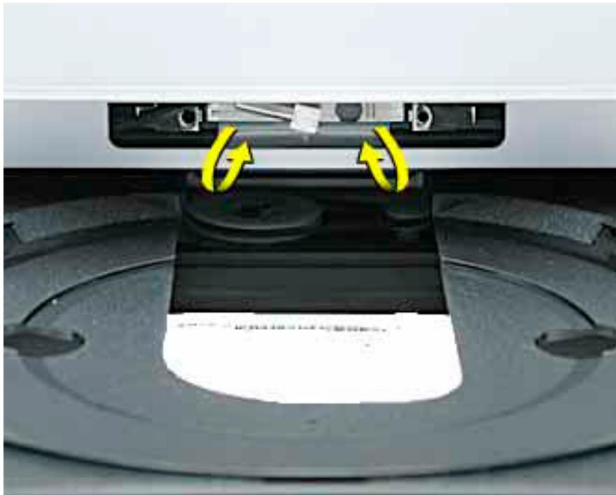
10. AirMac アクセスパネルを取り付け、ネジを締めます。
