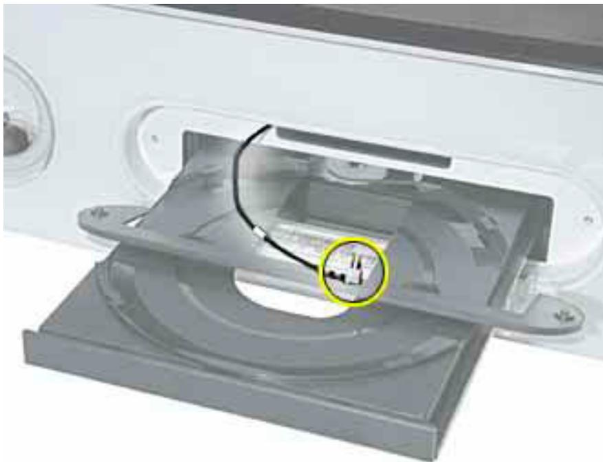
7. AirMac カードのロゴマークを下向きにして、カードをスロットに半分程挿入したままアンテナを接続します。
