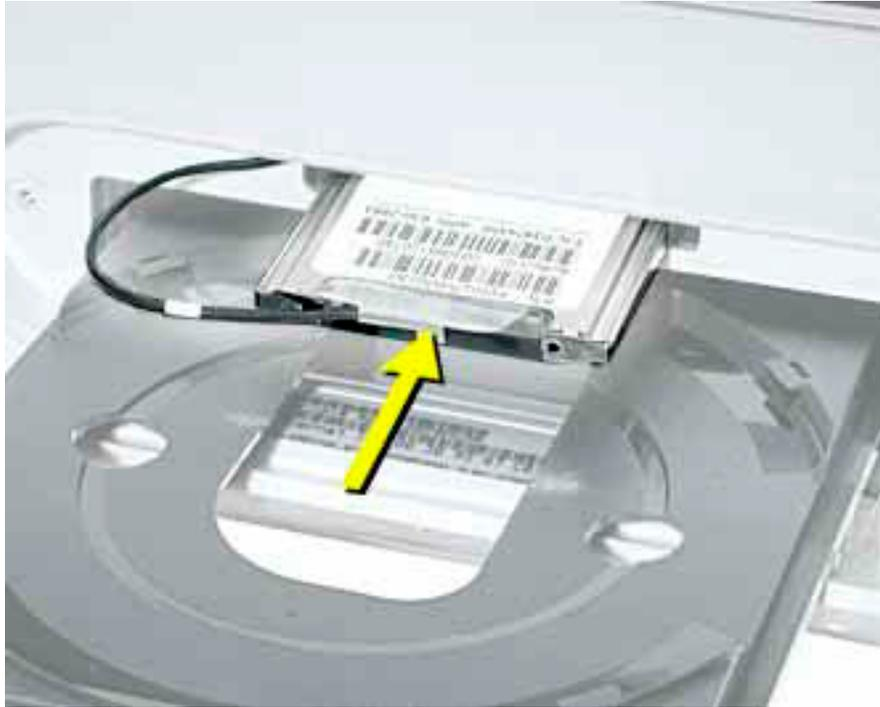
8. AirMac カードを押してスロットに取り付け、アンテナをスロットに収容します。
