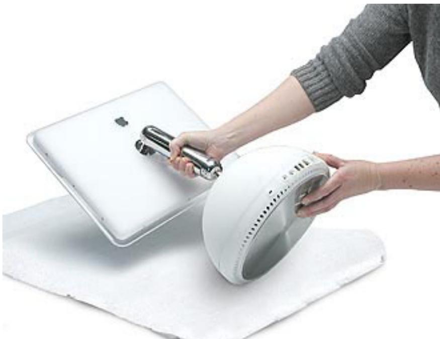
3. コンピュータのベース部にある4本の拘束型ネジをゆるめ、アクセスパネルを慎重に取り外します。(図2)
