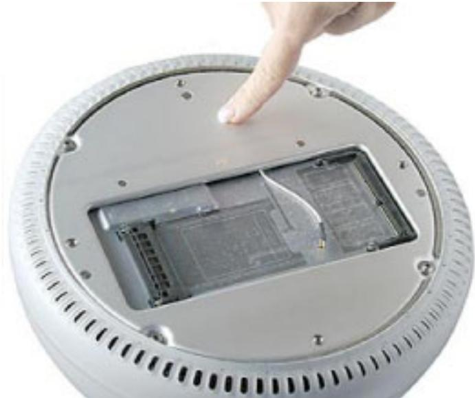
**【警告】** ボトムハウジングのネジには触れないでください。これらのネジを外したりすると、コンピュータ内部が異常な発熱を起こし故障の原因となります。(図4)
