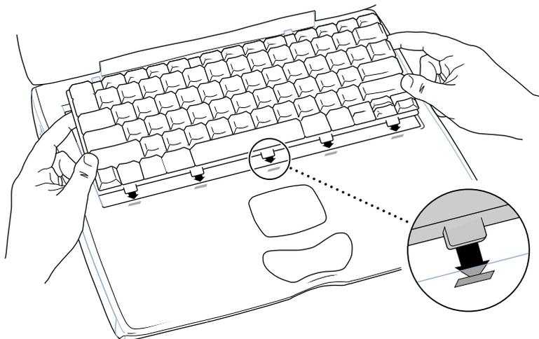
15. キーボード・リリースタブ (F1、F9 キーの左側) を引き下げ、キーボードの上部を下に押し下ろします。
