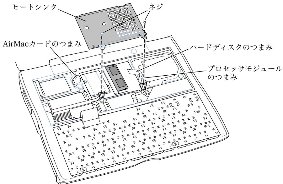
14. キーボードを元に戻し、ケースの穴にキーボード下端の小さな突起を差し込みます。
