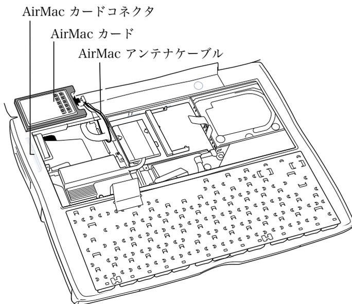
12. カードをスライドさせ、PC カードスロットの真上にあるコネクタに入れます。カードがコネクタに確実に接続されるまで、カードをスライドさせてください。
