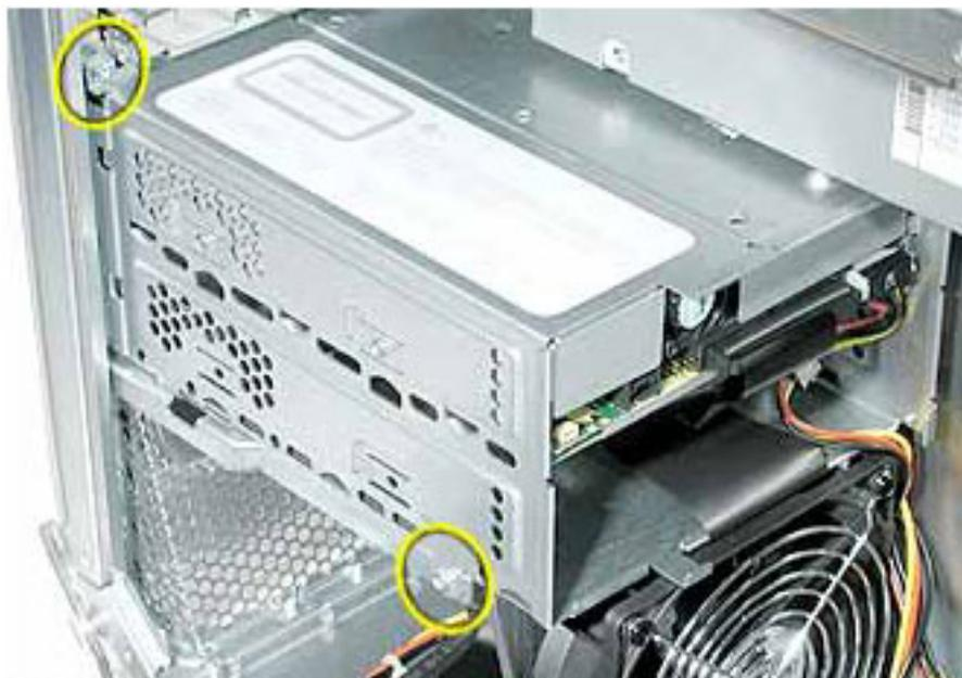
11. キャリアを後へスライドさせ、回転させてドライブケーブルに触れるようにします。
