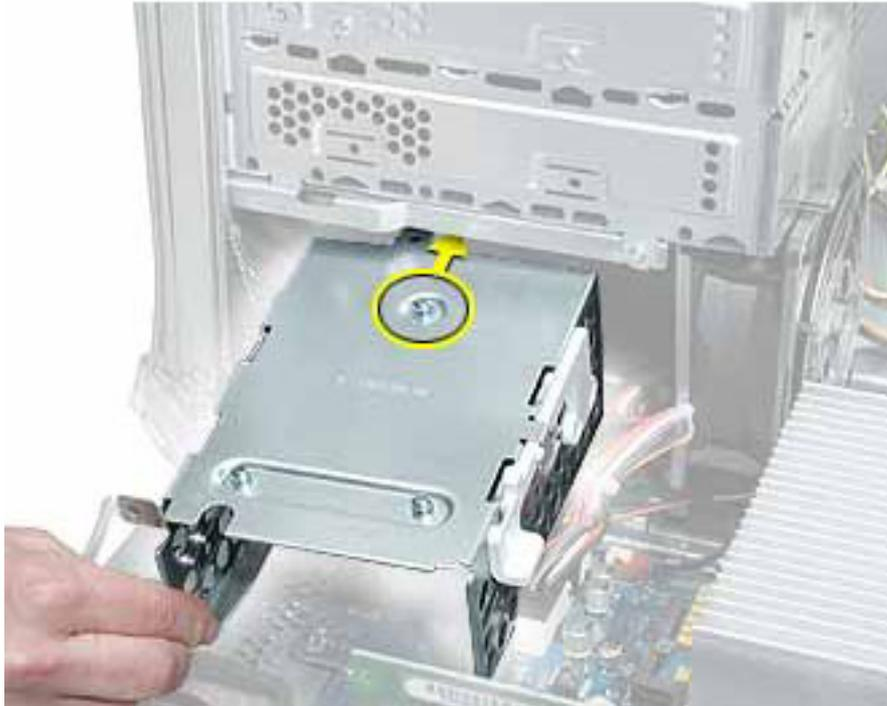
P4とP5の電源ケーブルコネクタがハードドライブに取り付けられているか、ハードドライブキャリアの下に収まっていることを確認してください。(図28)
