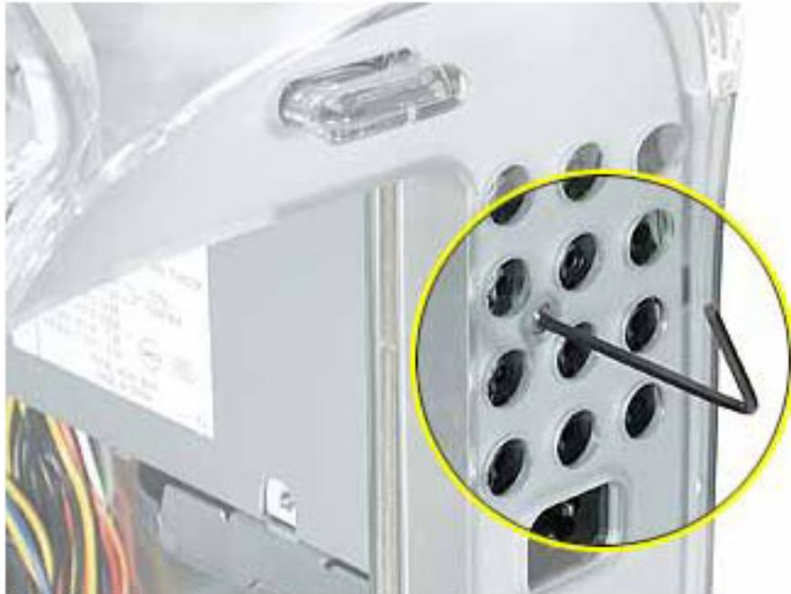
21. コンピュータの前面上部角の近くにある側面パネルから、電源の前のプラスネジを取り外します。(図17)
