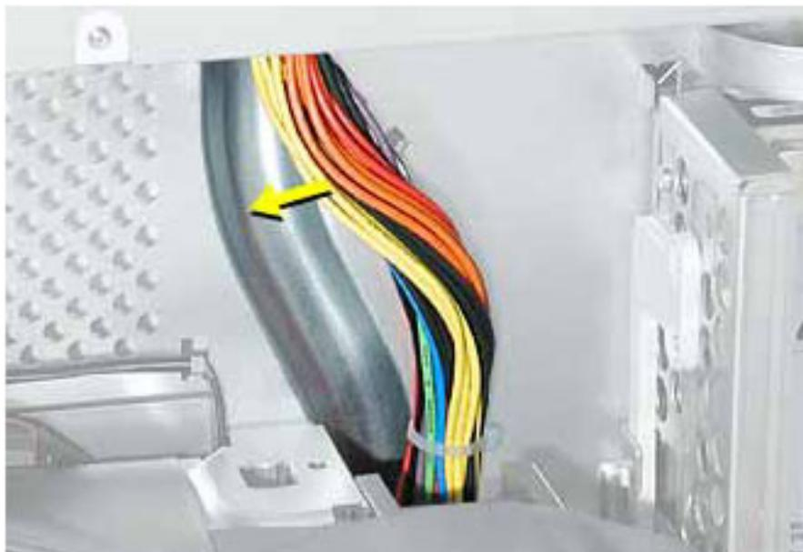
交換メモ: キャリアを光学式ドライブ棚に差し込んで戻すときに、キャリアの下側のとめ具がドライブ棚のくぼみに収まったことを確認してください。(図24)
