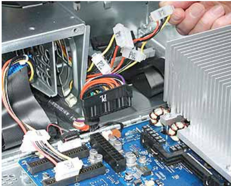
ケーブルガイドを使って、ケーブルの束を筐体底面に固定します。
