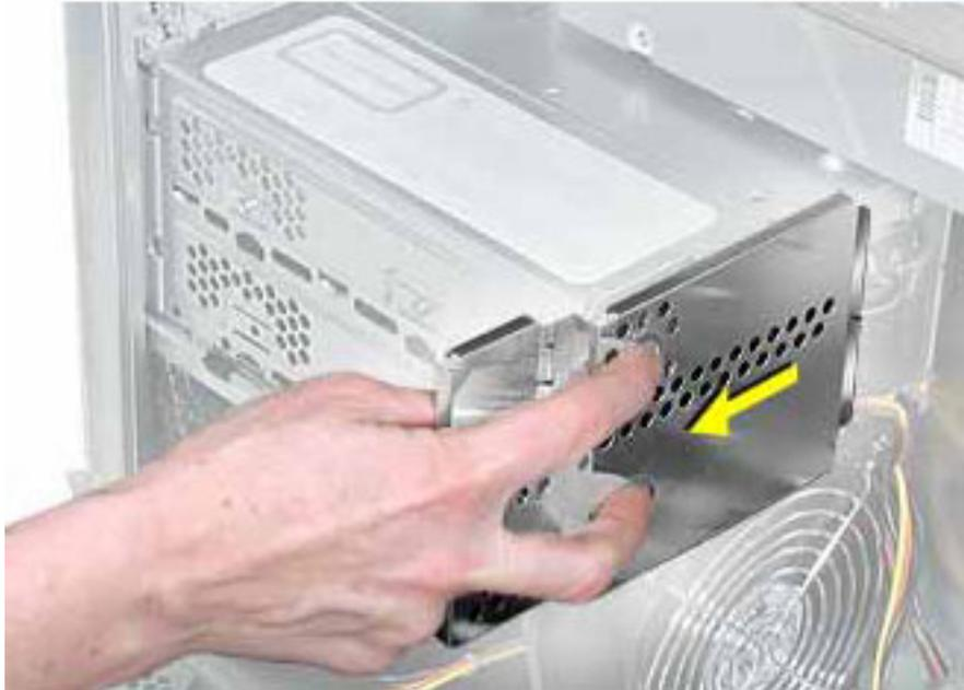
10. 光学式ドライブキャリアを筐体に固定している2つのネジを外します。(図7)
