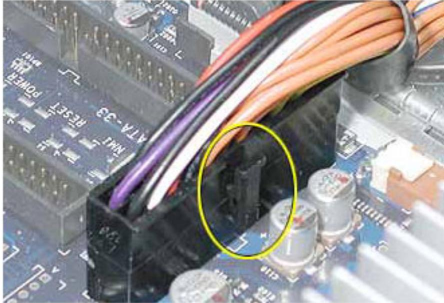
18 電源ケーブルを筐体の底にあるケーブルガイドから外します。(図14)
