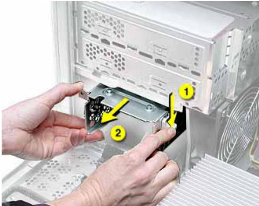
4. プラスドライバーを使って、背面ベイにあるハードドライブキャリアを筐体に固定しているネジ(1)を取り外します。(図4)
