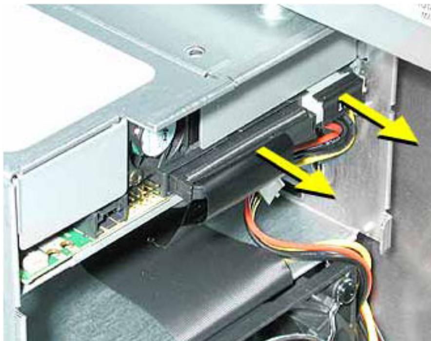
13. ATAリボンケーブルをロジックボードから外します。(図9)
