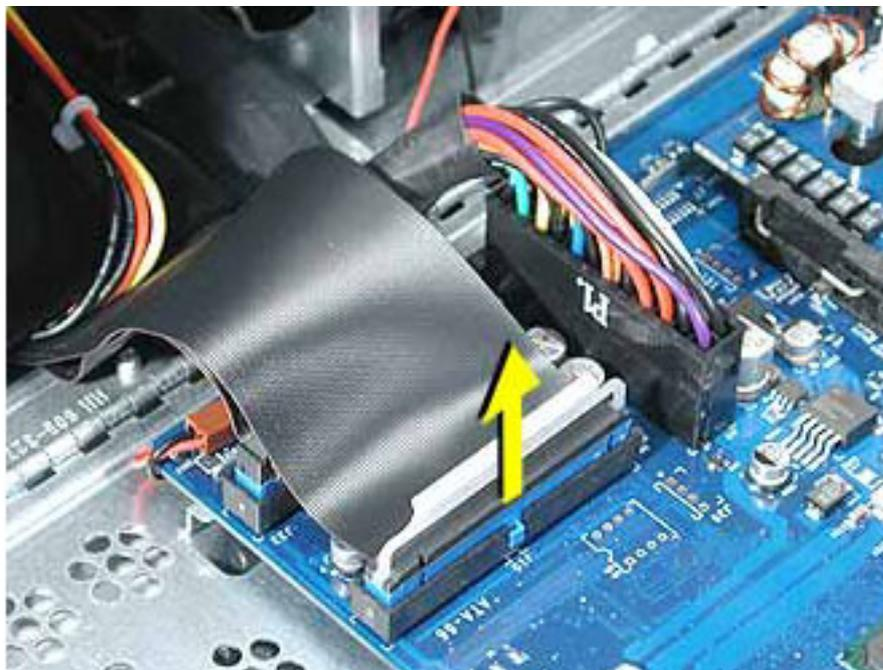
14. ロジックボードから2つ目のリボンケーブルを取り外し、折り返して下段のファンケーブルコネクタが見えるようにします。(図10)
